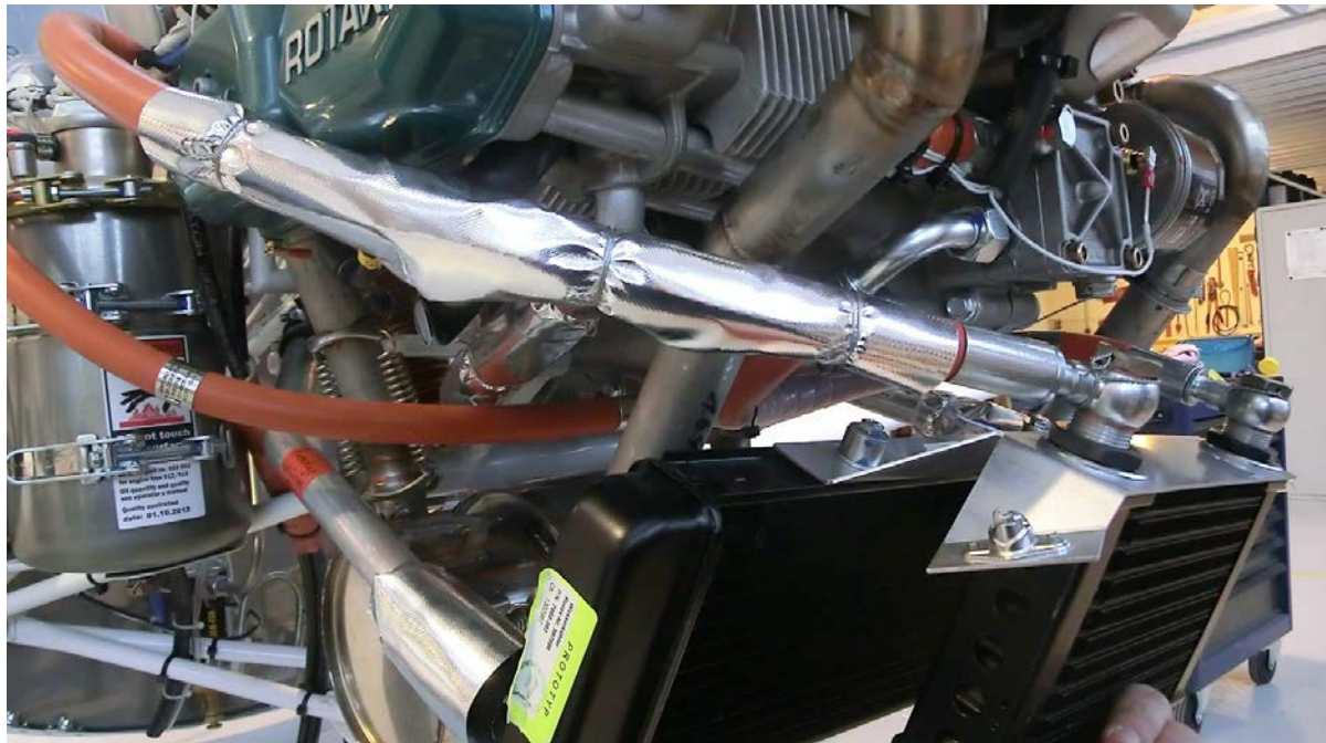
Bild 2: Einbau Kühlsystem, Ölsystem
