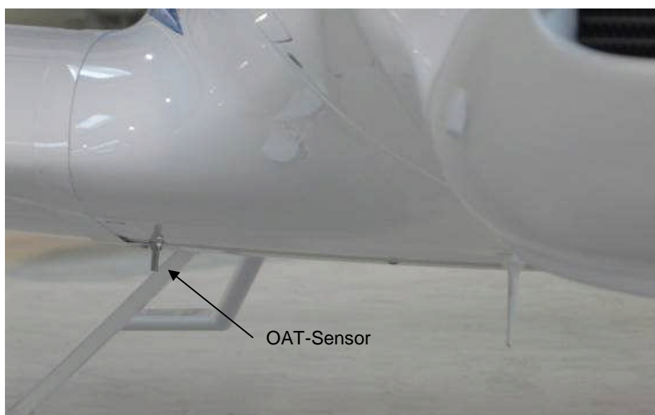
Bild 7 Neue Position des OAT-Sensors
