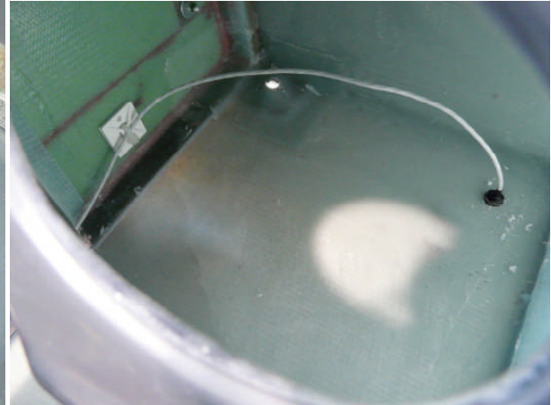
Bild 9 Klebesockel und OAT-Sensor von Innen
