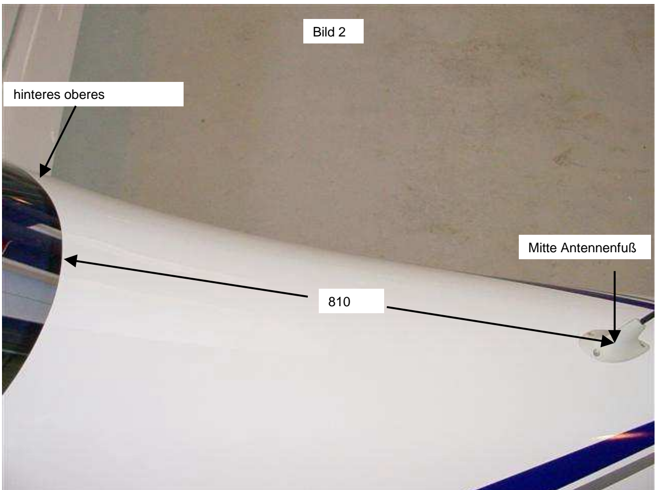
Bild 2: Position der ELT-Antenne auf dem Rumpf
